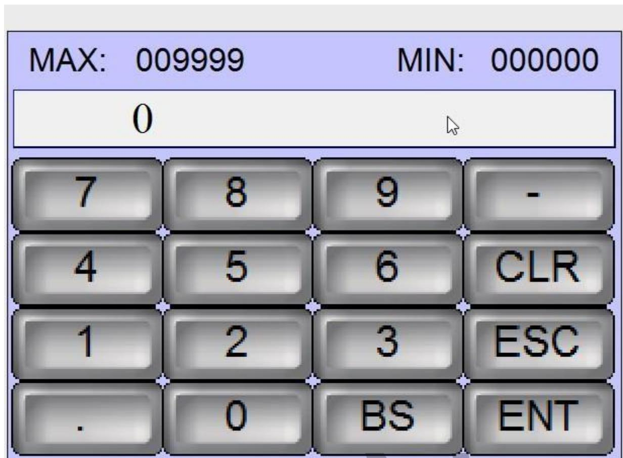
触摸数字键直接输入计划产量，按”ENT”键确认，又回到操作界面；
